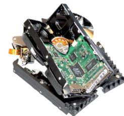
Durch einen Keil wird die Festplatte mittig gebogen. Für Hochsicherheitsanwendungen am besten mit Degaussing kombinieren. Sicherheitsstufe bei alleiniger Anwendung: H-3\*
