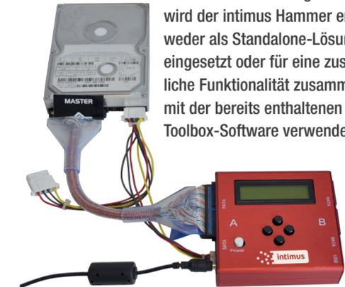
Für die Datenlöschung vor Ort wird der intimus Hammer entweder als Standalone-Lösung eingesetzt oder für eine zusätzliche Funktionalität zusammen mit der bereits enthaltenen CPR Toolbox-Software verwendet.
