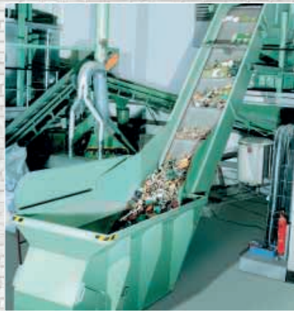
Vorzerkleinerung von Elektronikschrott (Leiterplatten)
