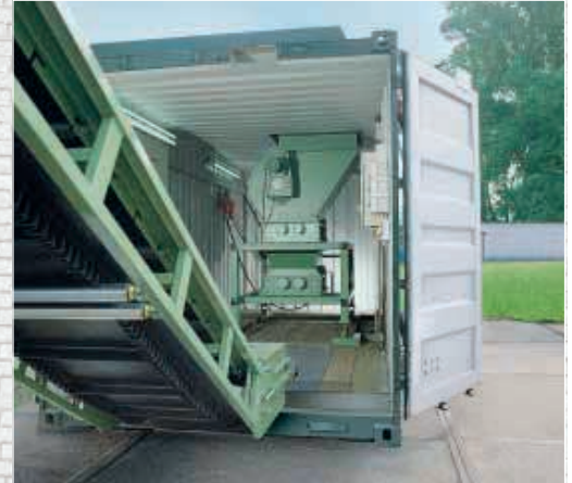
Transportabler Container mit eingebauter zweistufiger Zerkleinerungsanlage für Kunststoffbehälter
