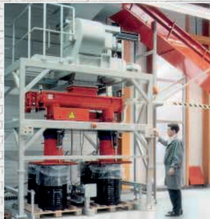
Anlage für das Recycling von Natrium-Dampflampen
